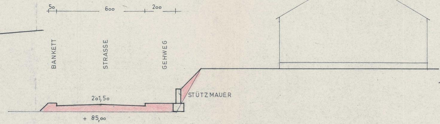
querschnitt 85,00 im längsschnitt C
